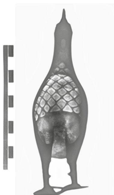
Afb. 7.5 Röntgenopname vanaf de voorzijde van het haantje (foto: Restaura).
